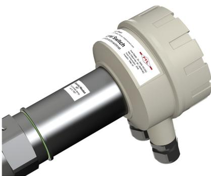
Damit die maximal zulässige Umgebungstemperatur der Elektronik aufgrund der Wärmeleitung über die Sonde nicht überschritten wird, ist bei HT-Ausführungen zwischen Sonde und Gehäuse ein Temperaturzwischenstück montiert. Alternativ kann hierzu auch die *separate Elektronikinstallation* verwendet werden.
